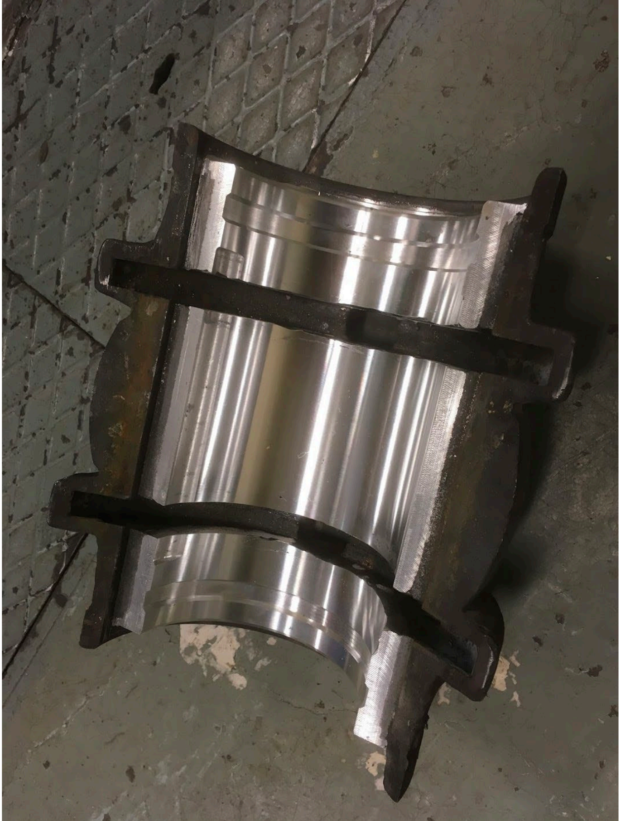
Renoverad lagerhalva inför montering.
